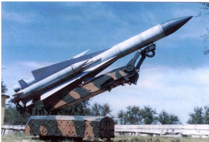
Зенитная управляемая ракета В-860П на пусковой установке
