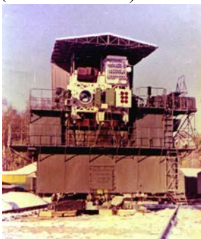
Оптический квантовый локатор наведения излучения мощных лазеров на цель (ОЛН) (Пост X1 и аппаратная кабина X2)
