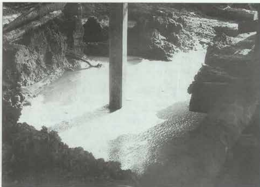
Возей. Воронка на устье скважины, возникающая из-за нарушения температурного режима вечной мерзлоты.
