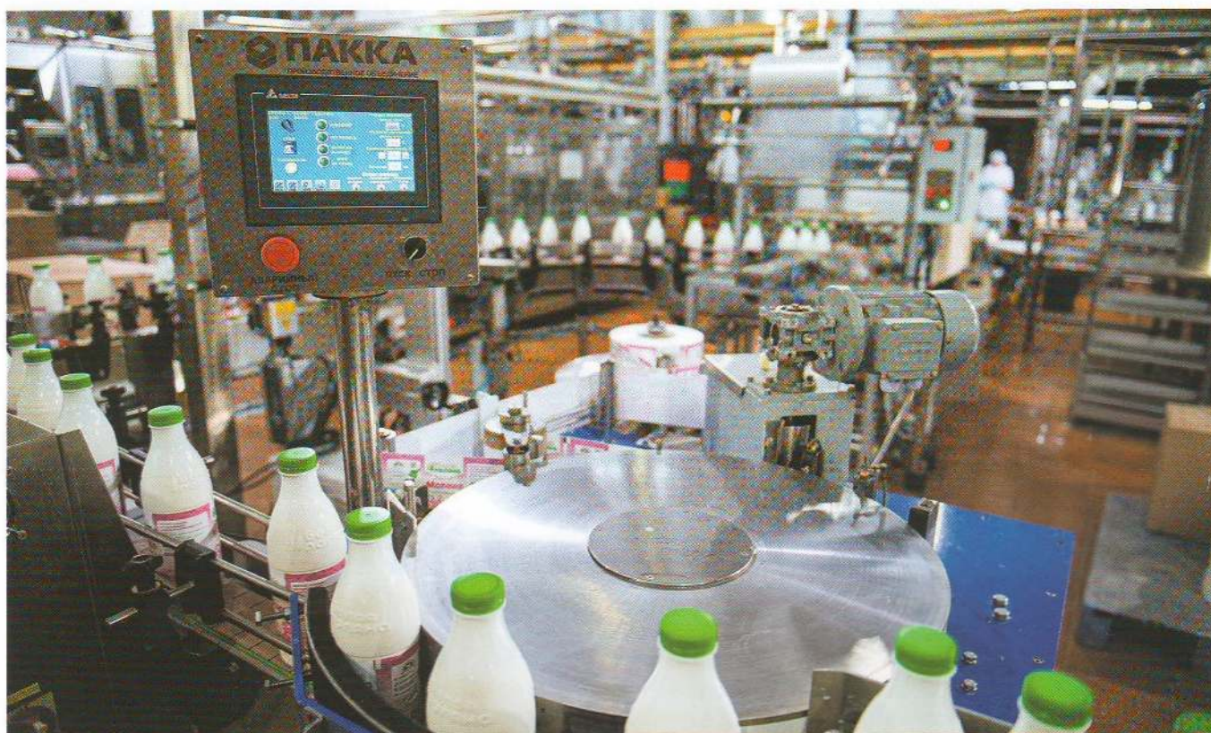
Автоматизированная линия по розливу молока в ПЭТ-бутылку
