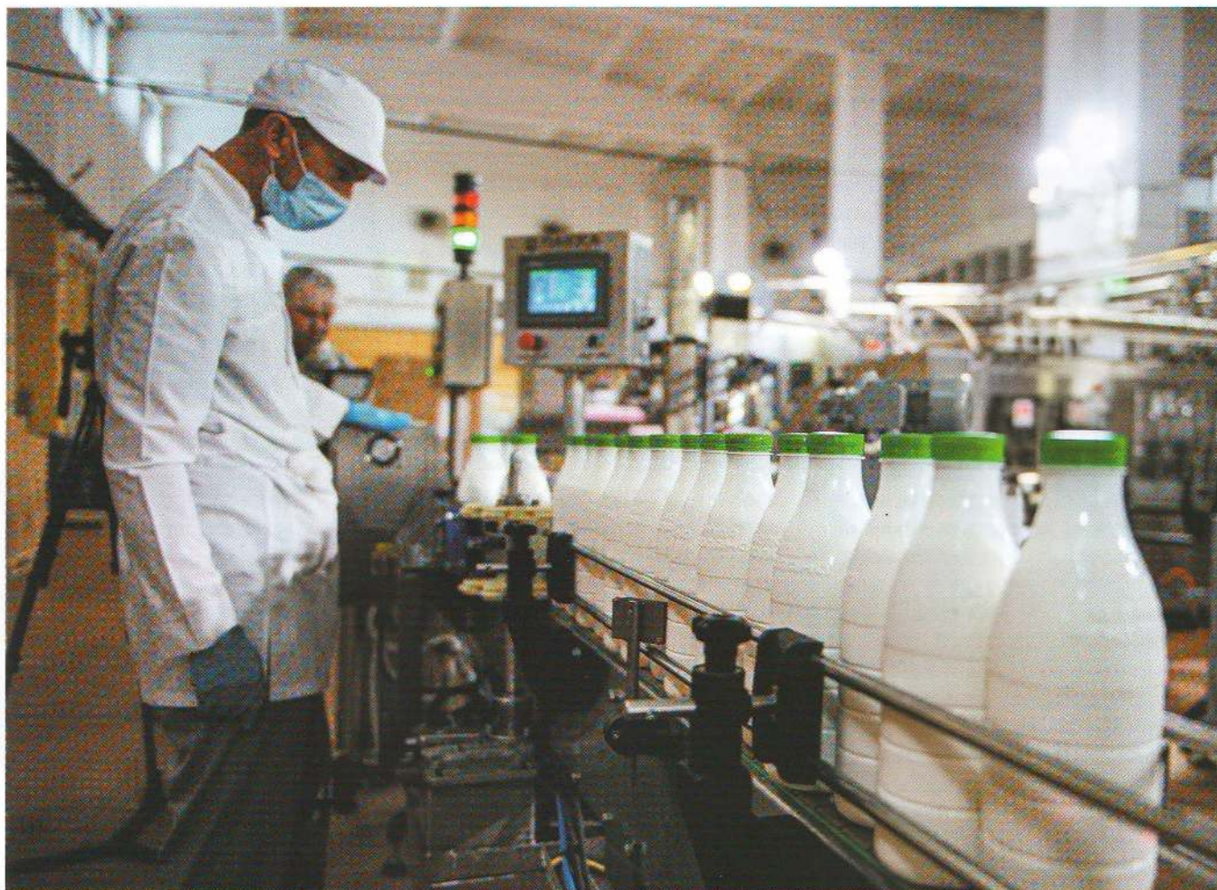
Подача ПЭТ-бутылки по пластинчатому транспортеру для нанесения этикетки
