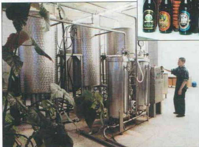
В этих купажных емкостях идет процесс приготовления безалкогольных напитков.
