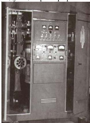
Рис.2.11-75 Шкаф входных приёмных устройств станции Б-200
