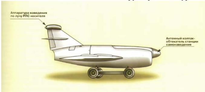
Рис. 2.10-9. Самолет-снаряд КС-1
