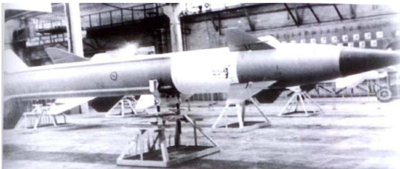
Рис. 2.11-70 Ракета 207Г в цехе Тушинского машзавода. В белый цвет окрашена часть корпуса, предназначенная для размещения атомного боезаряда.
