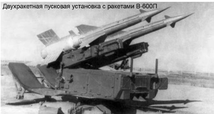
Двухракетная пусковая установка с ракетами В-600П
