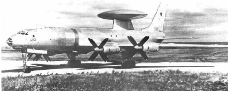
Рис. 2.11-89. Авиационный радиолокационный комплекс дозора «Лиана», установленный на самолёте Ту-126
