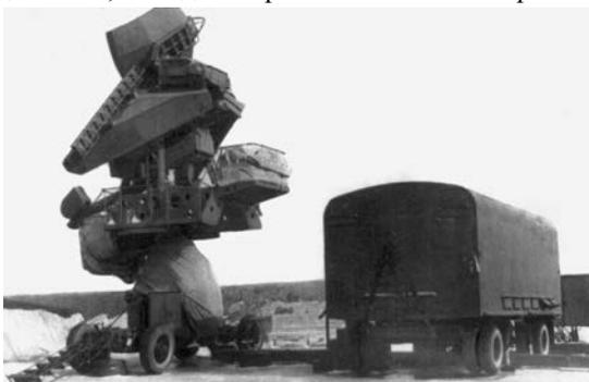
Рис. 2.13-30. Стрельбовый радиолокатор (антенный пост УНВ, аппаратная кабина УНК)
