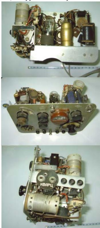
Рис. 2.6-6. Внутреннее устройство радиостанции "Север". На нижней фотографии виден разъем для подключения кварцевого резонатора
