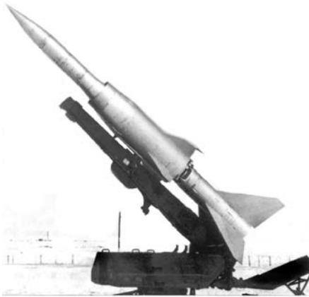
Рис. 2.13-27. Ракета 12Д (предназначена для поражения цели на дальностях до 40 км и высотах до 25 км, летящими со скоростями до 2300 км/ час)
