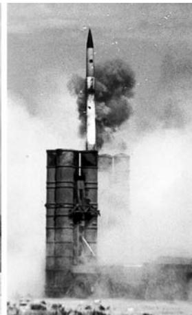
Рис. 2.18-17. Пусковая установка с ракетами 5В55Р и старт ракеты
