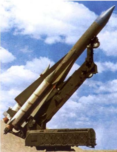
Рис.2.13-61.Ракета 5В21 на пусковой установке.
