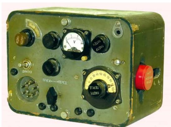
Рис. 2.6-5. Радиостанция «Север» (габариты: 2100 x 1500 x 1150мм)
