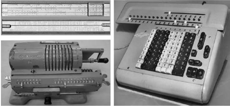
Рис. 2.17-2. Докомпьютерная вычислительная техника: логарифмическая линейка, механический арифмометр "Феликс" и электромеханический калькулятор "ВМП-4"
