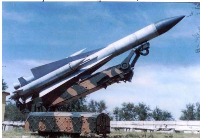
Рис. 2.13-50. Зенитная управляемая ракета В-860П на пусковой установке
