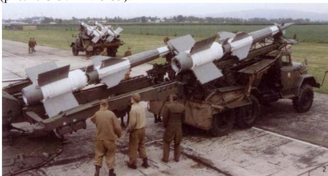
Рис. 2.13-36. Заряжание ракетами 5В27 пусковой установки
