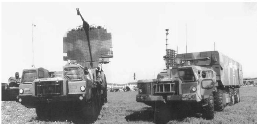
Рис. 2.18-14. Командный пункт системы: пункт боевого управления(справа), радиолокатор обнаружения кругового обзора
